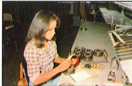
Le esclusive bobine in piattina di alluminio avvolta di costa vengono dotate di supporto dopo l'avvolgimento e una prima cottura.
