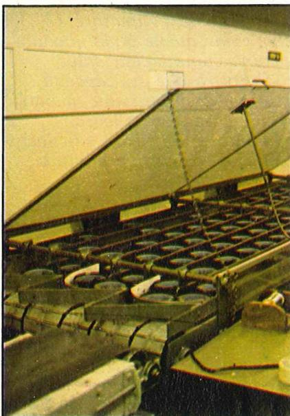
La linea di produzione completamente automatica dei «driver» delle 901. In primo piano una «linea di ritardo» che dà il tempo ai collanti di essiccare prima della lavorazione successiva.
