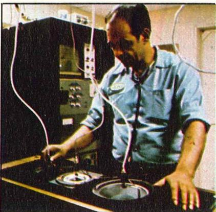
Il collaudo della AR-9 avviene con la tecnica della misura in campo ravvicinato, operando una somma elettrica delle risposte rilevate dai vari microfoni.
